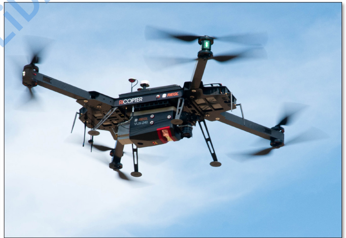
VUX-240 在集成 APX-20 UAV 和垂直下视的 RGB 相机后, 也能轻松安装在 RICOPTER 无人机上
